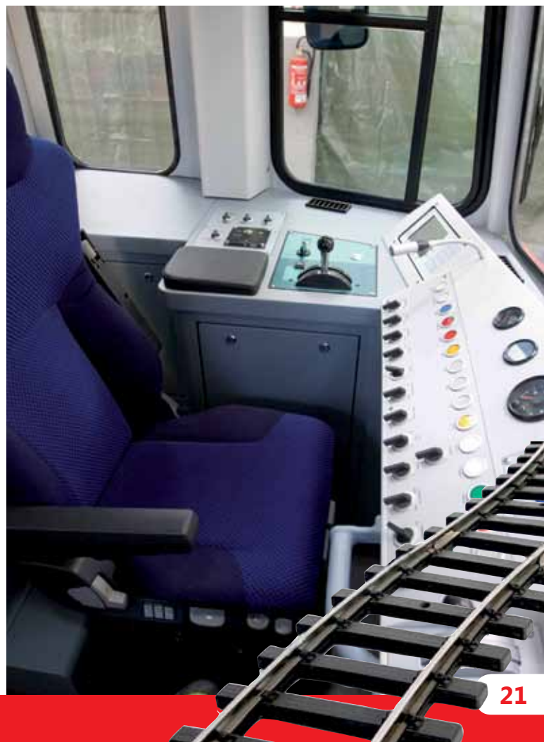
Der Fahrerarbeitsplatz in den alten Stadtbahnwagen aus den Jahren 1974 bis 1977 (Foto oben) hat sich in einen modernen Fahrerarbeitsplatz verwandelt, der den heutigen ergonomischen Standards entspricht (Foto unten).
